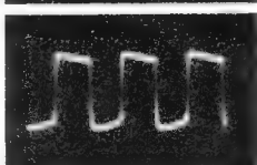
Bild 7. Verformung einer 500-Hz-Schwingung durch den gleichen Verstärker; nur geringe Änderungen gegenüber Bild 5
