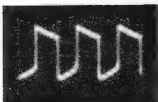
Bild 6. Verformung einer 200-Hz-Rechteckschwingung durch einen Verstärker; Dachschräge infolge der unteren Grenzfrequenz
