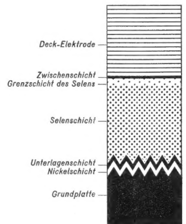
Bild 4. Schematischer Aufbau einer Selengleichrichterplatte
